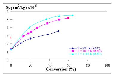
Figura 4 Influencia de la conversión del sólido sobre el desarrollo de área específica de los carbones activados preparados con CO<sub>2</sub> a diferentes temperaturas.
