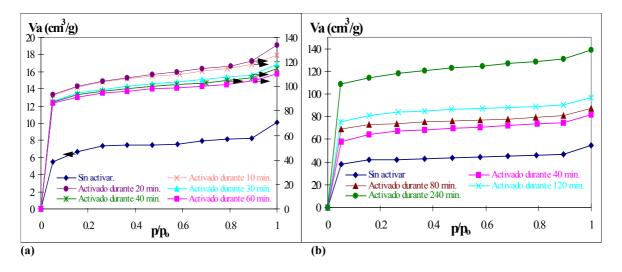
Figura 1 Isotermas de adsorción de N<sub>2</sub> a 77 K sobre los carbones activados preparados a distintos tiempos de activación:
