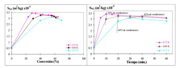
**Figura 2.** Influencia de la conversión del sólido alcanzada a diferentes temperaturas sobre el desarrollo de área especifica de los carbones activados obtenidos.
