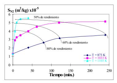
Figura 5 Efecto del tiempo de activación sobre el desarrollo de área específica de los carbones activados preparados con CO<sub>2</sub> a distintas temperaturas.
