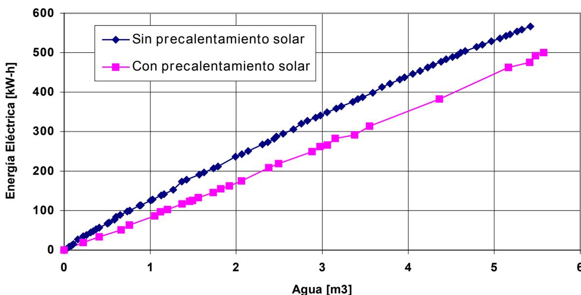
Fig. 4. Consumos comparados de E.E., en función del consumo de agua, con y sin precalentamiento solar en época invernal.
