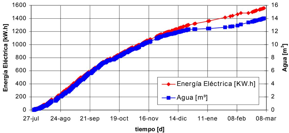
Fig. 2. Consumos de Agua y E.E. sin precalentamiento solar.
