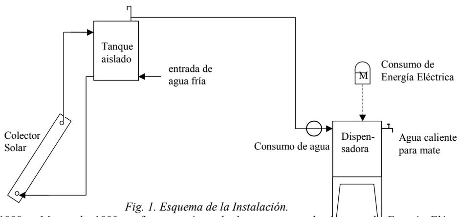
Fig. 1. Esquema de la Instalación.
