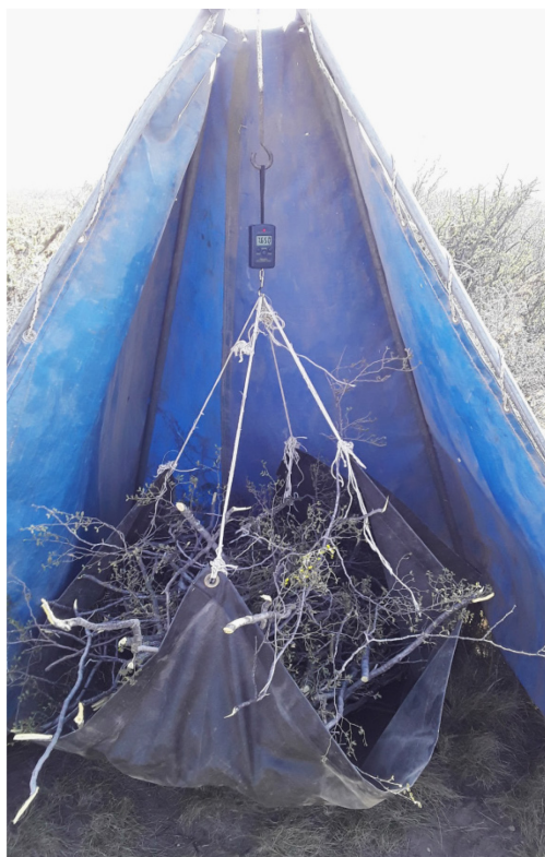
Figura 3: Determinación de la BRPh a campo con balanza de gancho digital.
