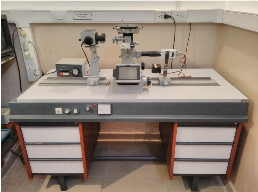
**Figura 2.3** Banco metalográfico - Rietchert
