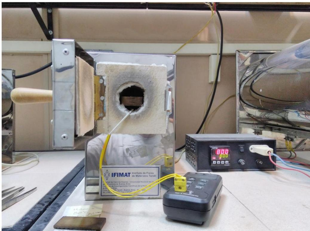
**Figura 2.1:** Horno resistivo con puerta utilizado para los tratamientos térmicos
