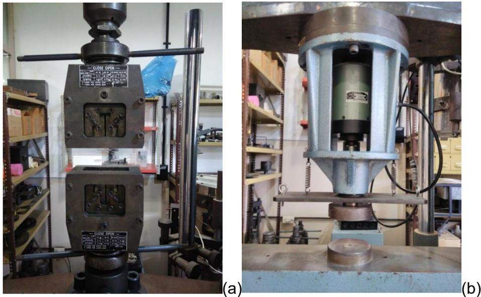
**Figura 2.7** Arreglos de la maquina universal de ensayo.
