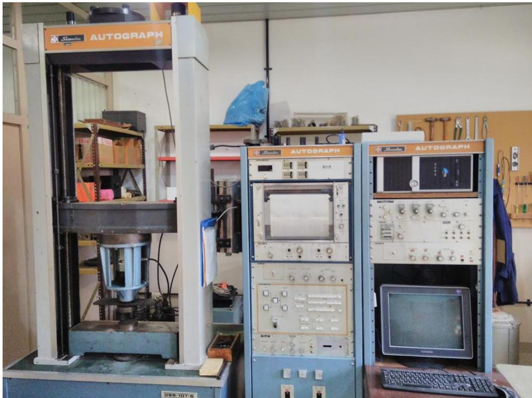
**Figura 2.6** Máquina universal de ensayos Shimadzu Autograph DSS-10T-S
