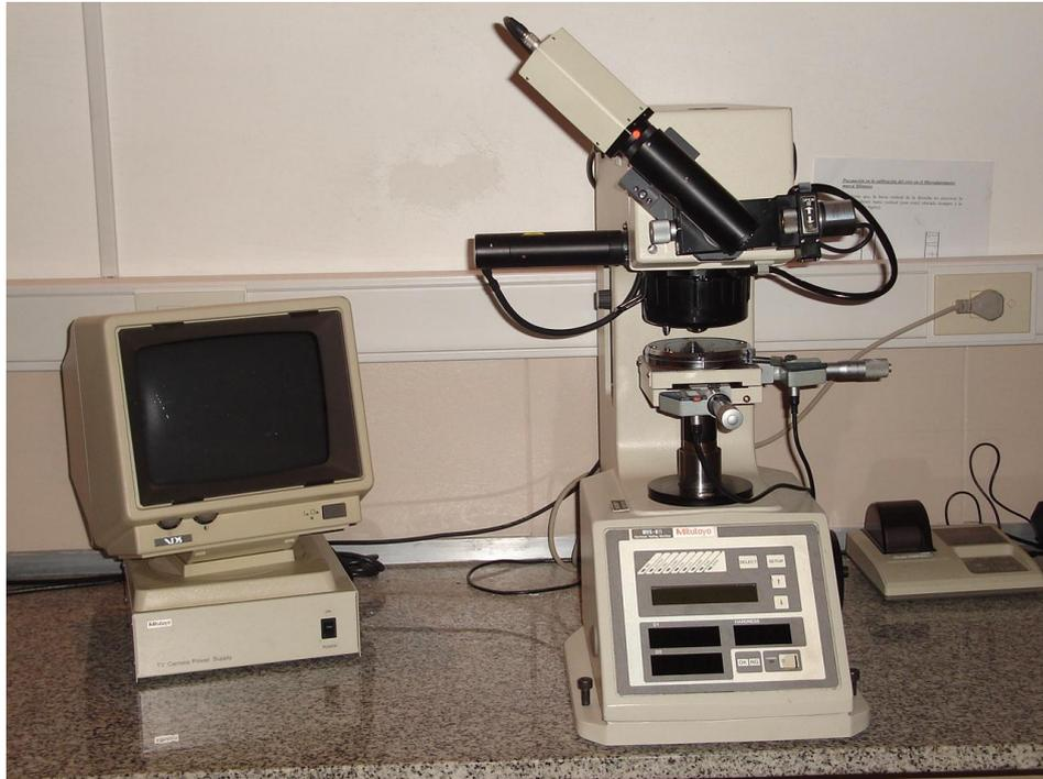
**Figura 2.5** Microdurómetro Mitutoyo MVK-H1
