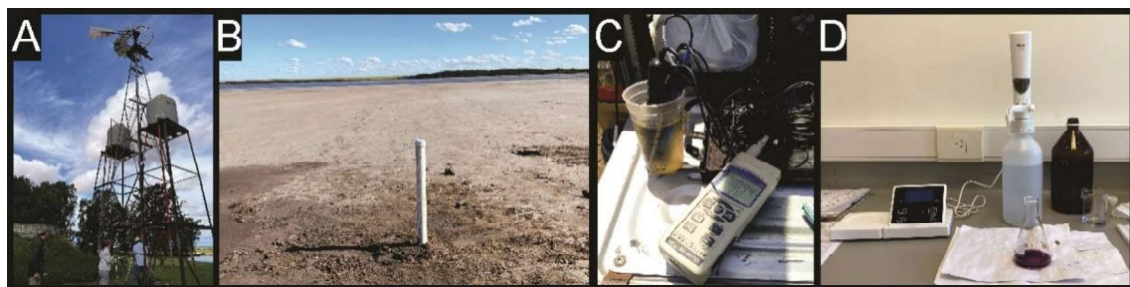
Figura 3. a. Toma de muestras de agua subterránea de molinos. b. Freatímetro para tomar muestras de agua subterránea somera. c. Medición de parámetros in situ . d. Determinación de iones mayoritarios en laboratorio; técnica de titulación.
