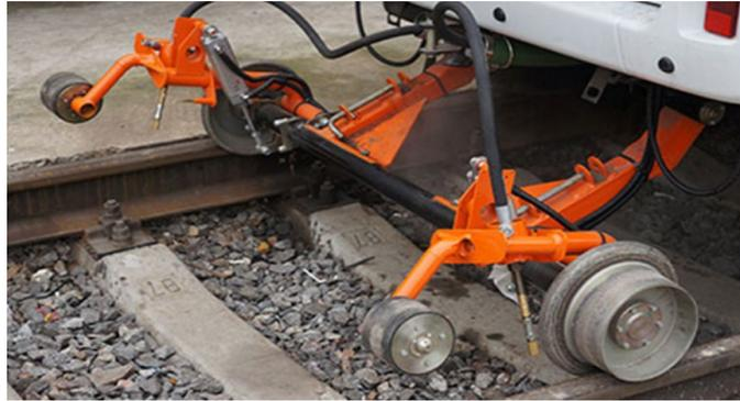
Figura 6: Vehículos específicos de lubricación de la vía
