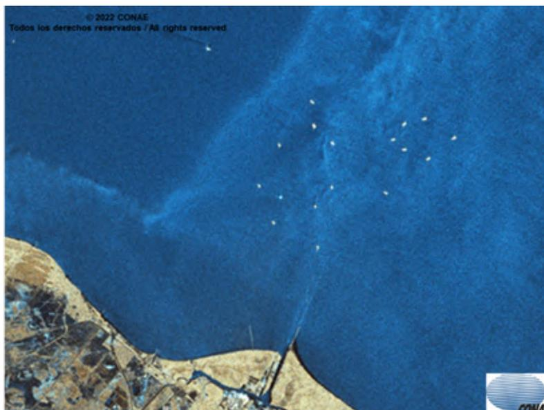
Fig. 7. Imagen SAOCOM-1A del 29/01/2019 (Río de La Plata, costa de Berisso y Ensenada). Producto StripMap Dual Pol – Haz 2. Polarización VV-VH. Combinación de Falso Color. Pasada Descendente. Se destacan los barcos (puntos blancos) esperando la entrada al puerto (Fuente CONAE).
