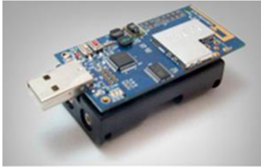
Figura 3. 2. Mota TelosB modelo CM5000
