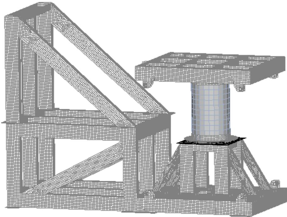
**Figura 12.** Modelo de elementos finitos del BEM
