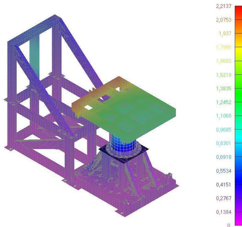
**Figura 15.** Desplazamientos [mm] – Caso de carga combinado
