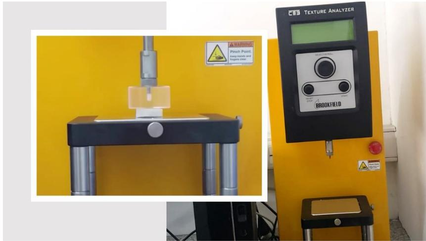
**Figura 2.14.** Texturómetro Brookfield PRO CT con una sonda TA4/1000.
