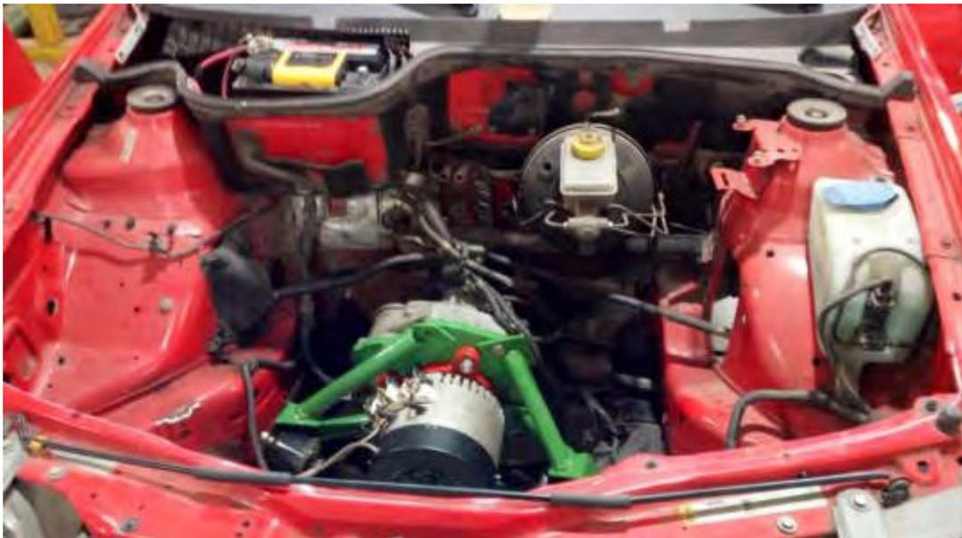
Figura 7 Soporte de motor eléctrico para Volkswagen Gol Power
