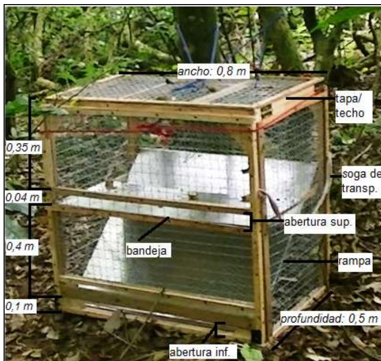
Figura 6.1. Dispositivo-caja: componentes y dimensiones
