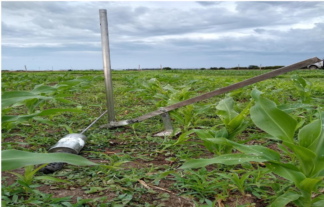
Figura 9. **Barreno utilizado para la toma de muestras de suelo húmedo para el posterior cálculo de humedad edáfica.**
