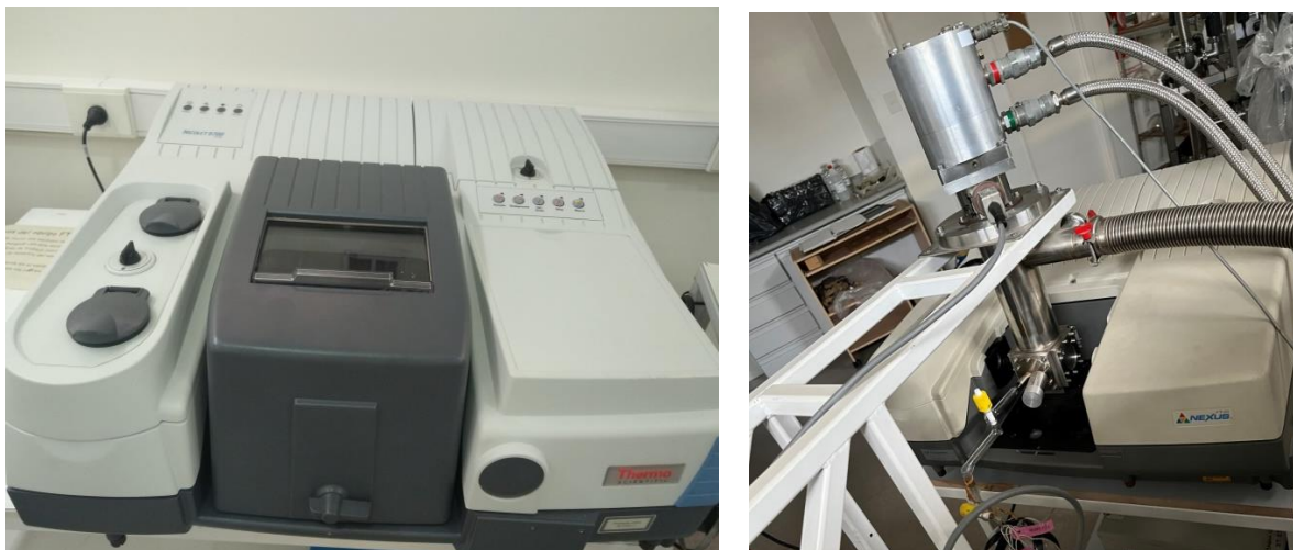
Figura 2.4. Espectrómetros FTIR Thermo Nicolet: modelo 6700 (izquierda) y modelo Nexus (derecha).
