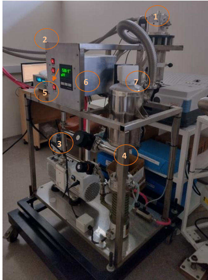
Figura 2.6. Equipo de matrices de 4 K. Se observa el módulo principal del criostato (1) conectado al compresor mediante mangueras (2). El sistema de vacío posee una bomba mecánica (3) y una bomba difusora (4). En la parte superior se puede ver el lector de temperatura (5) y del manómetro (6), y la trampa para N_2 (7).
