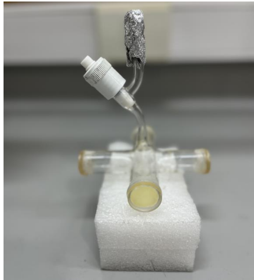
Figura 2.12. Celda en cruz utilizada para las experiencias fotoquímicas en fase gaseosa. Se observan una de las ventanas de KBr coloreada luego de una experiencia debido a la formación de un producto poco volátil.
