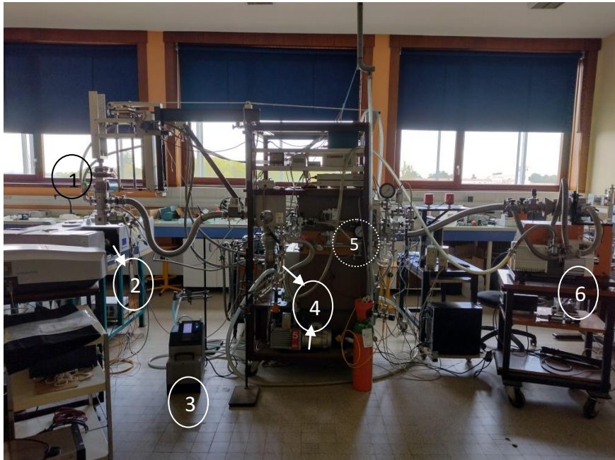
Figura 2.8. Equipo de matrices del ISM de la Universidad de Bordeaux, Francia. Se pueden observar el cabezal de la matriz (1), el espectrómetro FTIR (2), el chiller (3), el sistema de vacío de la matriz (4), las líneas de vacío (5) y el sistema de vacío de las líneas.
