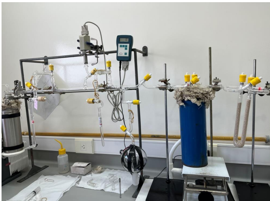
Figura 2.3. Línea de vacío de CEQUINOR para la preparación de mezcla de gases. Conectadas a la línea (de izquierda a derecha): trampas verticales con las sustancias de interés, balón de 1 L, trampa en U sumergida en un baño a \sim -90 °C y trampa en U conteniendo un tamiz molecular para la purificación del Ar.
