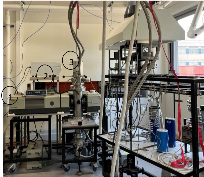
Figura 2.10. Equipo de matrices del PIIM, Universidad de Marseille. Equipo FTIR (1), espectrofotómetro UV-visible (2) y cabezal de la matriz (3).
