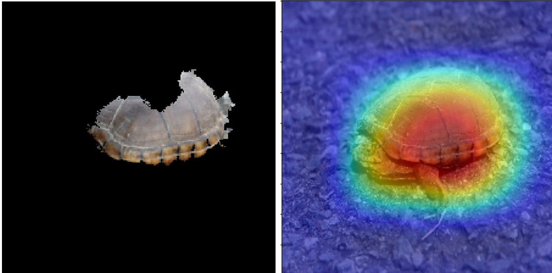
Figura 24: Se muestran a la izquierda los super-pixeles resultantes de LIME y a la derecha el mapa de calor resultado de Grad-CAM.
