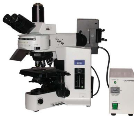
Figura 2.9 Microscopio óptico de epifluorescencia y de campo abierto Olympus BX51 utilizado en el presente trabajo.
