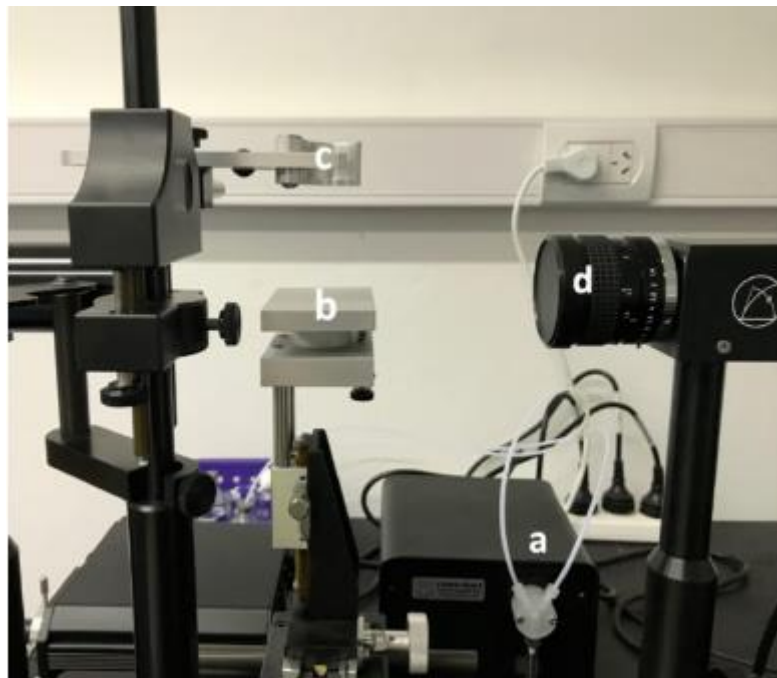
Figura 2.8. Goniómetro empleado. a) Bomba y mangueras por las que circula el líquido. b) Base porta muestras donde se coloca la muestra. c) Brazo que sujeta el tip por donde se vierte la gota durante la medida. d) Cámara.
