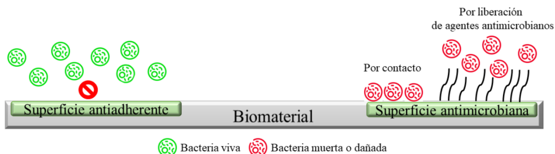
Figura 1.3. Esquema representativo de modificaciones superficiales de características antiadherentes o antimicrobianas en biomateriales.
