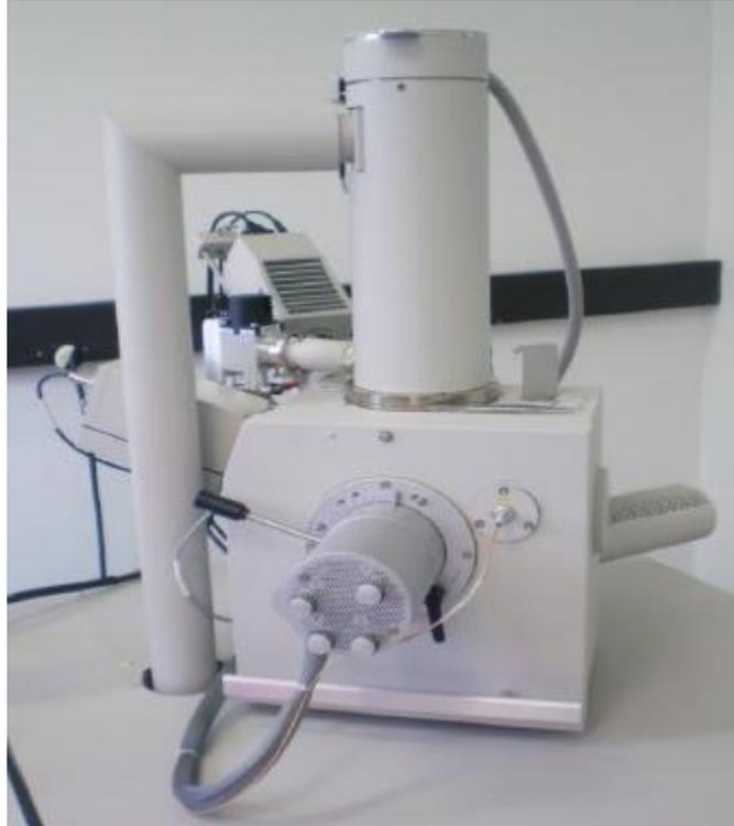
Figura 4.2: Microscopio electrónico de barrido ambiental (ESEM) utilizado para el presente trabajo.
