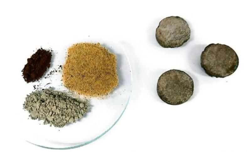
Figura 4.4: Componentes y pastillas fabricadas con PHE y cemento.
