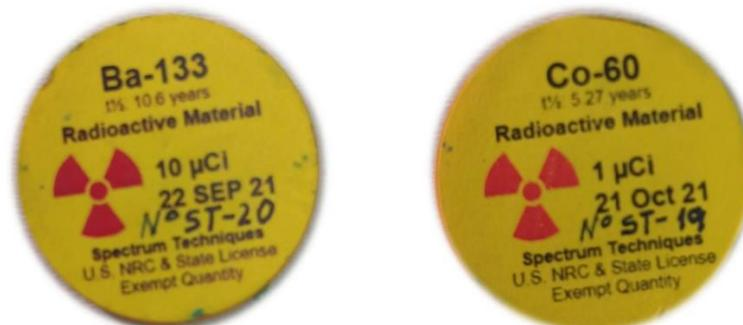
Figura 4.10: Dos de las fuentes radiactivas patrón utilizadas en este trabajo.
