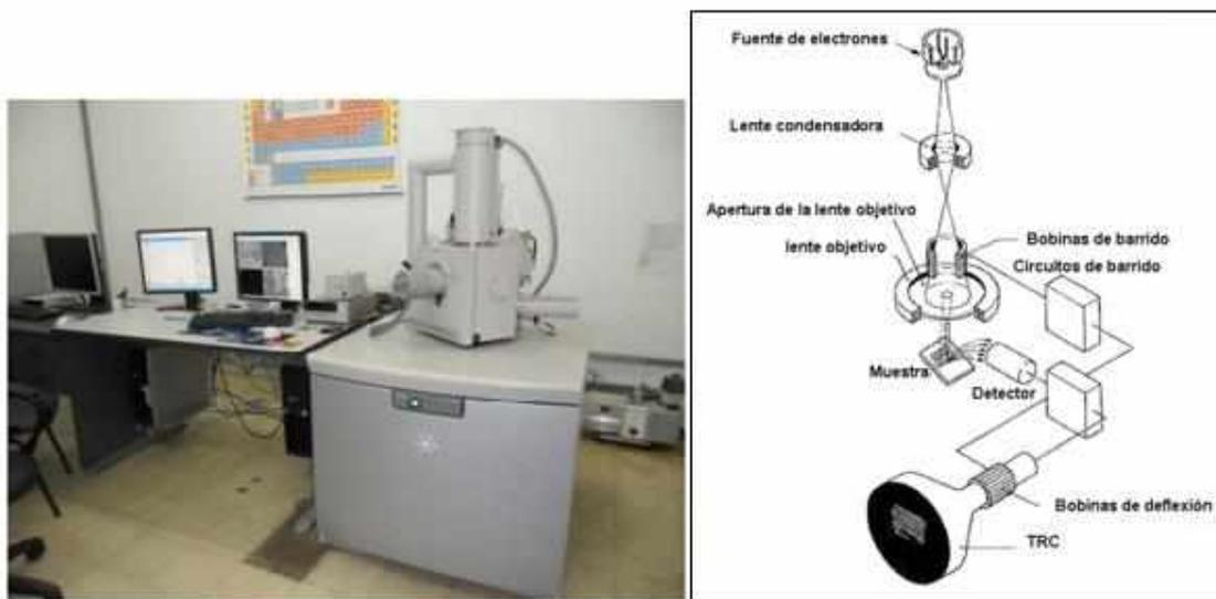
Figura 7. Microscopio Electrónico de Barrido Ambiental, FEI Quanta 200 y Diagrama esquemático.
