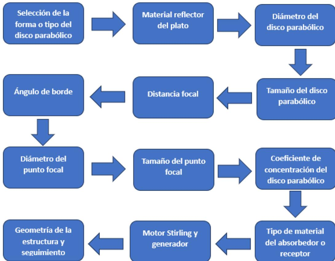
Figura 116 - Pasos para diseñar un disco solar parabólico
