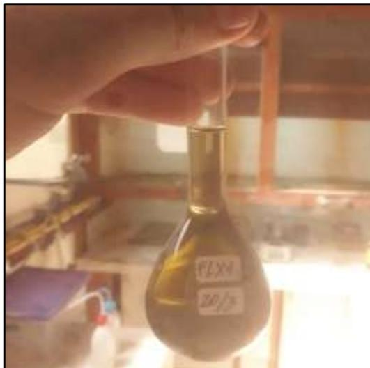
**Imagen 4.1:** Solución de lixiviado del material catódico de celda tipo NMC obtenida mediante el tratamiento hidrometalúrgico.
