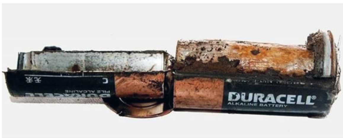
FIGURA 2. Vista general de pila luego de su apertura. Fuente: autores del artículo
