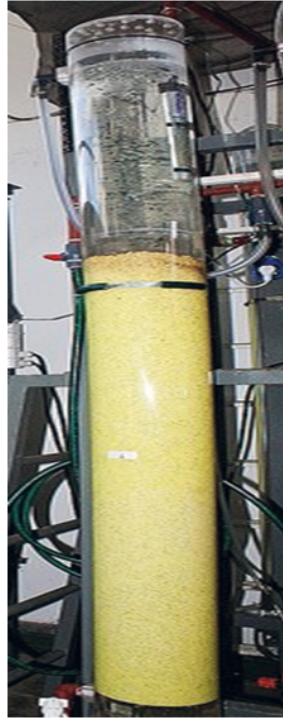
FIGURA 3. Vista general de la torre de producción de ácido sulfúrico mediante bacterias. Fuente: autores del artículo.
