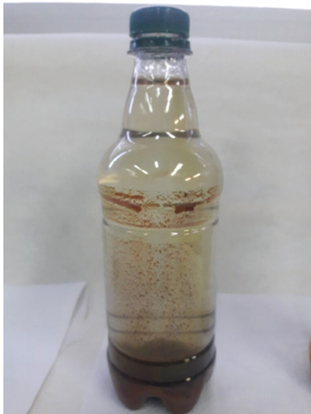
FIGURA 1. Se observa el proceso corrosivo y de destrucción que ocurre en una pila introducida en agua corriente posterior a 90 días. Fuente: autores del artículo.
