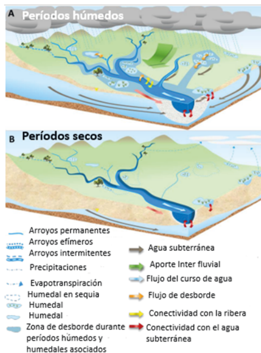
FIGURA 1. Vinculación de los humedales con el agua superficial y subterránea en las cuencas hidrográficas durante hidrop periodos húmedos y secos. Fuente: autor del artículo a partir de EPA, 2015.
