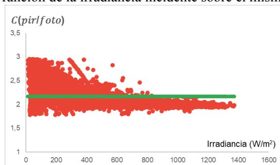
Figura 1: Cociente entre voltajes de los radiómetros CMP21 y Fotovoltaico, en rojo. En verde se muestra el valor medio de la serie de datos
