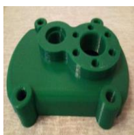
Figura 2. Pieza impresa con tecnología FMD.
