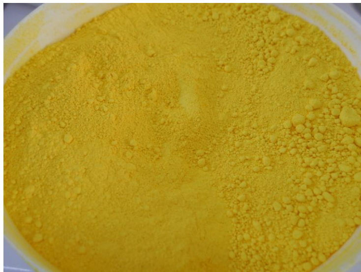
Fig. 3.3. TCZ, pigmento anticorrosivo en las formulaciones clásicas de wash primers para aluminio.
