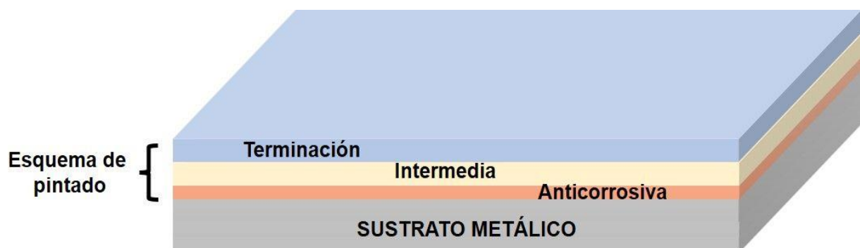
Fig. 1.2. Esquema de pintado sobre una superficie metálica.
