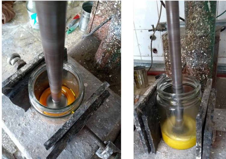
Fig. 6.5. Preparación de las pinturas epoxídicas de base acuosa en la dispersora de alta velocidad.
