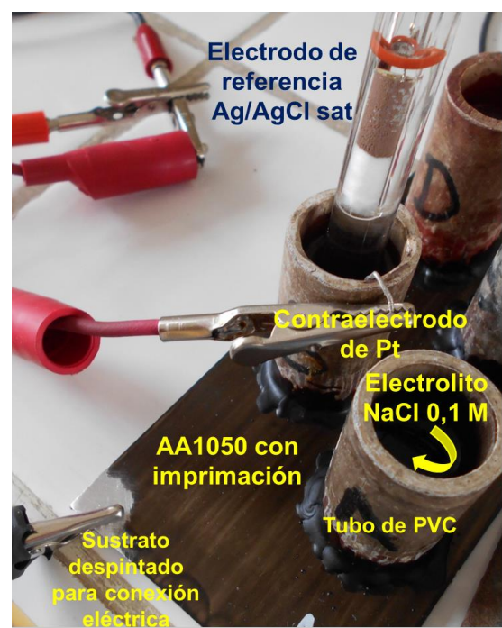
Fig. 6.3. Celdas construidas sobre los paneles imprimados.
