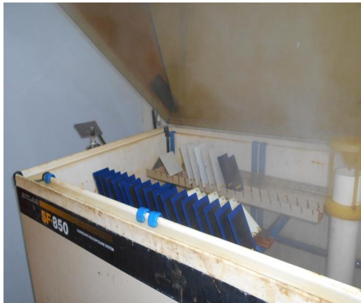
Fig. 6.7. Cámara de niebla salina Atlas SF850.
