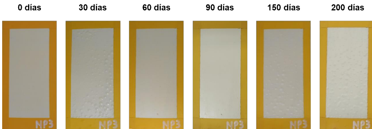
Fig. 8.30. Aspecto de los paneles iNUB al inicio y luego de 30, 60, 90, 150 y 200 días de exposición en la cámara de humedad.
