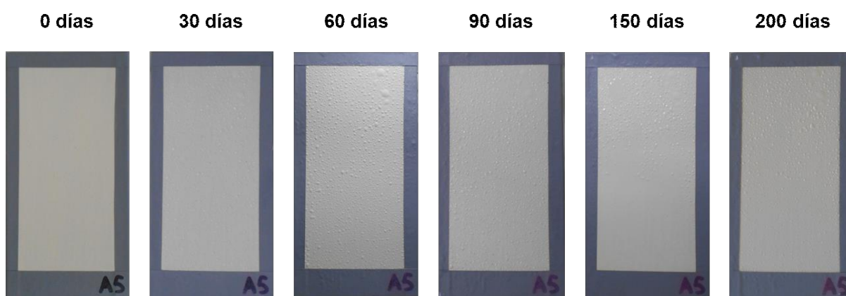
Fig. 8.35. Aspecto de los paneles fAGUA al inicio y luego de 30, 60, 90, 150 y 200 días de exposición en la cámara de humedad.
