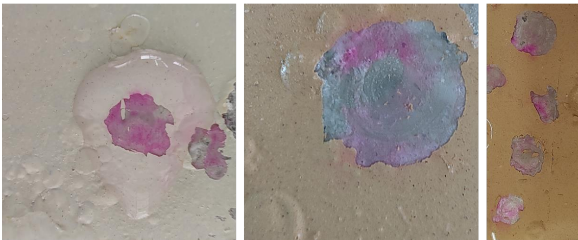
Fig. 8.56. Ampollamiento catódico. La reacción de reducción del oxígeno en la periferia de las ampollas da lugar a un pH alcalino que se detecta mediante el viraje del indicador fenolftaleína a un color rosado intenso.
