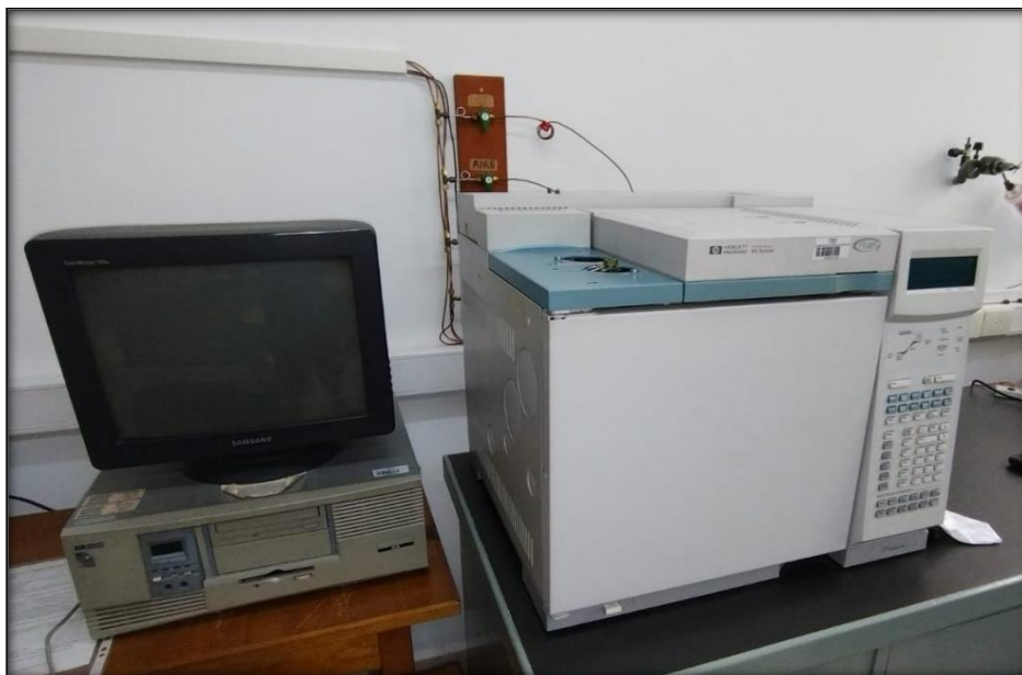
Figura 2.8. Cromatógrafo gaseoso acoplado a detector de ionización por llama empleado en el análisis de ácidos grasos (derecha). Computadora para adquisición y análisis de datos (izquierda).
