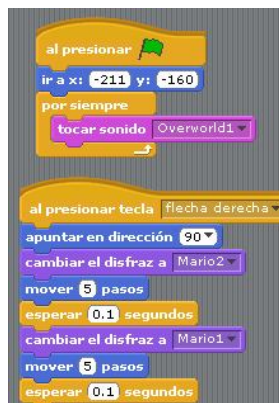
Figura N° 3: Ejemplo de las estructuras de control en Scratch
