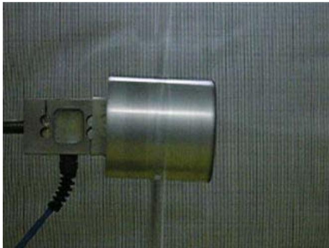
**Figura 0.10** Pararrotor montado sobre el rodamiento basculante durante un ensayo.  $\beta_1 \neq \beta_2$ .
