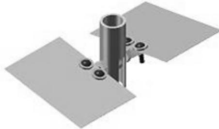
**Figura 0.8** Representación típica del modelo de pararrotor estudiado.
