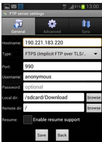
Figura 5-18: Configuración del cliente FTPs
