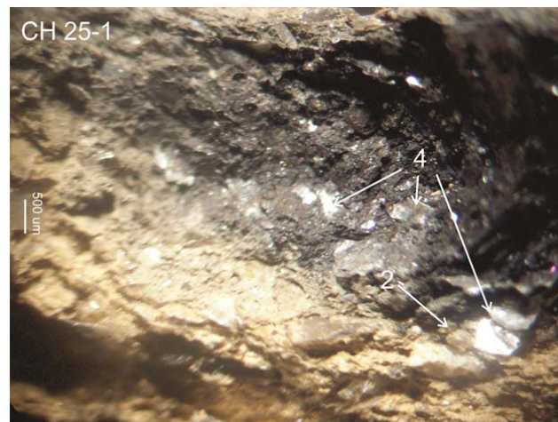
Figura 6.7 Pasta del GP 6 en lupa binocular, del sitio CH 25-1. Ref.: 2: cuarzo; 4: muscovita.
