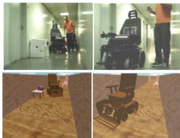
Fig. 2. Posições de movimento da cadeira de rodas em duas fases tanto no mundo real como na sua representação virtual. No canto superior esquerdo é possível ver a cadeira de rodas real na posição inicial do seu movimento e no canto inferior esquerdo a sua representação virtual. No canto superior direito da mesma figura é possível ver a cadeira de rodas real na posição final do seu movimento e no canto inferior direito a sua representação virtual.
