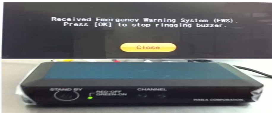
Figura 5. Recepción de la alarma ante recepción de la señal de emergencia
