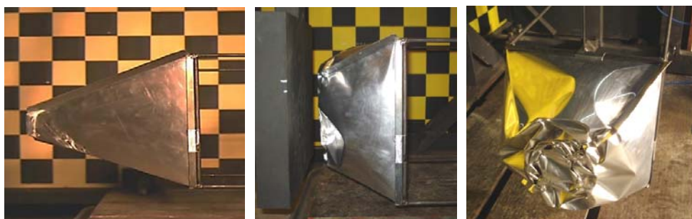
Atenuador antes de ser impactado y posterior al mismo.
