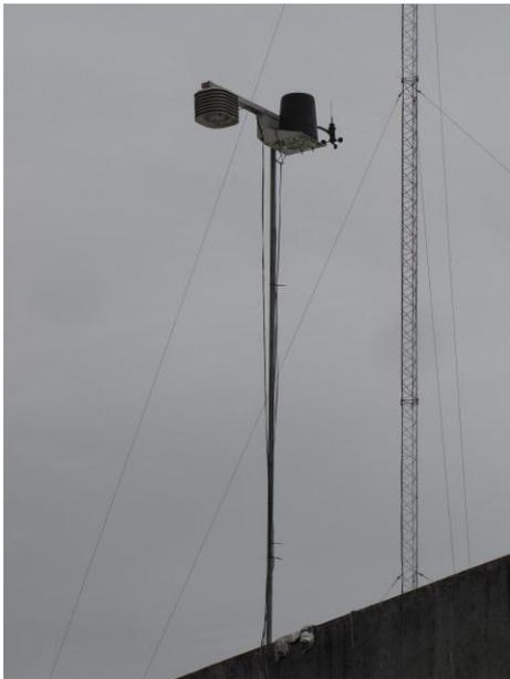
**Figura II.7:** Fotografía que muestra la estación meteorológica del Punto A (Universidad Tecnológica Nacional). A la izquierda se observa el recinto donde se halla el medidor de humedad y el sensor de temperatura. A la derecha el anemómetro y la veleta de direcciones.
