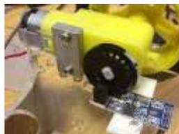
*Figura 7: Módulo Optoacoplador tipo “herradura”.*
