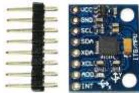
*Figura 6: Sensor Giroscopio MPU-6050.*
