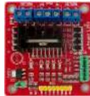
*Figura 5: Puente H Módulo L298.*
