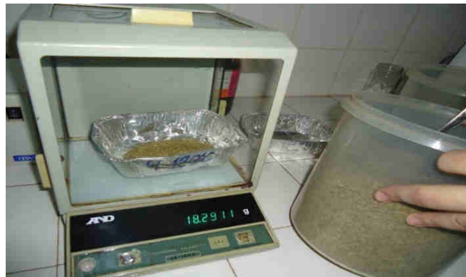
Fig. 3. Balanza digital de precisión para obtener distintas muestras.
