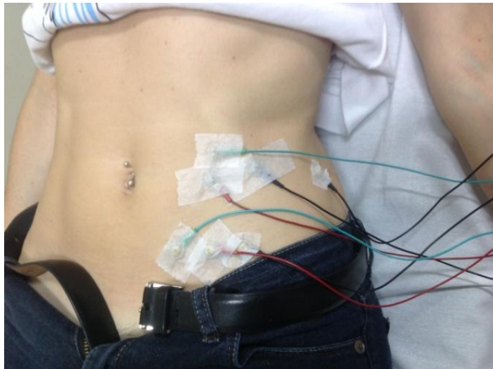
Fig. 2.2. Individuo con electrodos de superficie durante la evaluación de EMG
