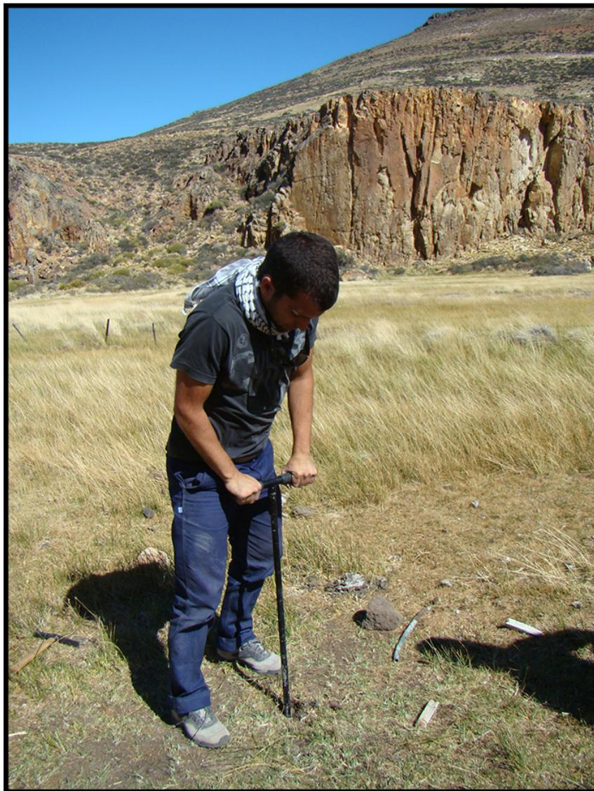
Figura 5.2: Extracción de muestras mediante barreno helicoidal en el Mallín La Primavera. La foto corresponde al muestreo MLP1.
