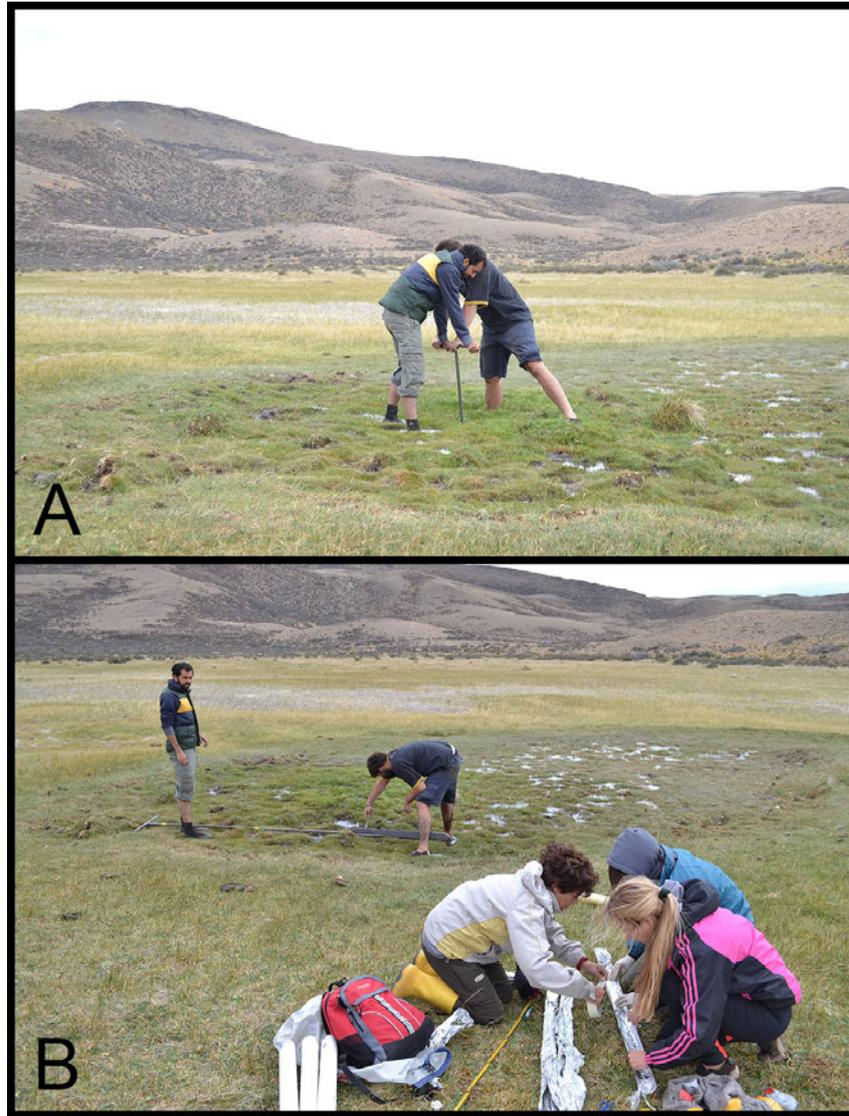
Figura 5.6: A. Extracción de testigos sin disturbar de un sector húmedo del mallín. B. Empaquetamiento de la columna para su transporte al laboratorio.
