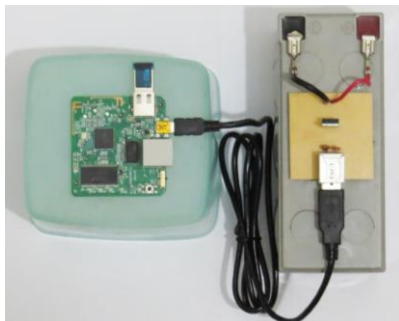
Fig. 4. Nodo alimentado por una batería externa
