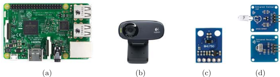
Figura 1: Módulos que componen el hardware. (a) Raspberry Pi 3. (b) Cámara web. (c) Sensor de luminosidad. (d) Emisor y receptor infrarrojos.
