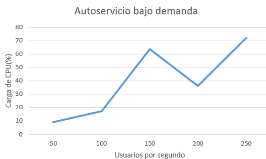
Figura 2. Autoservicio bajo demanda. El eje Y representa la Carga de CPU (%) y el eje X la cantidad de Usuarios por segundo . Luego del punto determinado por 150 usuarios por segundo y 62% de carga, la CPU disminuye debido a su autoescala en base a la demanda de los usuarios, por lo que queda demostrada la característica.
