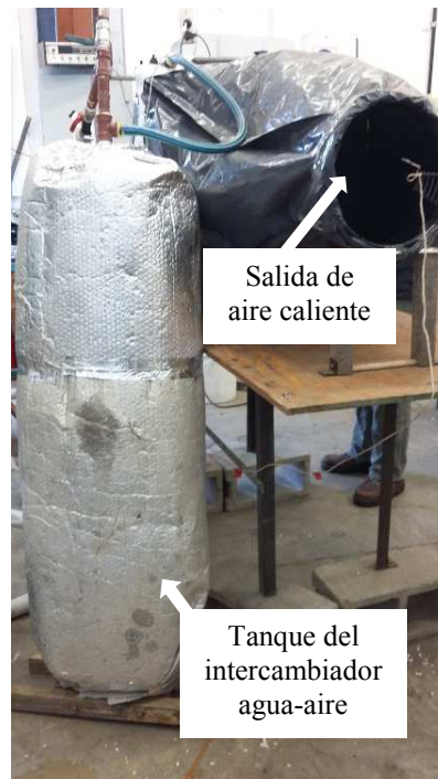
Figura 3 b) Intercambiador agua-aire ensayado Flujo termosifónico
