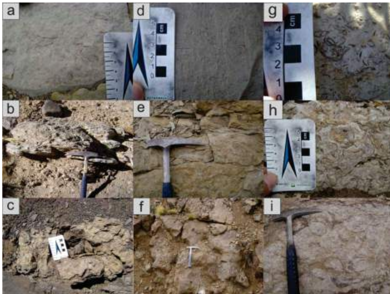
Figura 5.4. Facies sedimentarias carbonáticas y no clásticas. a) Facies de wackestones masivos; b) facies de wackestones laminados; c) facies de wackestones bioturbados; d) facies de packstones masivos; e) facies de packstones bioturbados; f) facies de packstones con estructuras monticulares; g) facies de floatstones masivos; h) facies de rudstones masivos; i) facies de bindstones .
