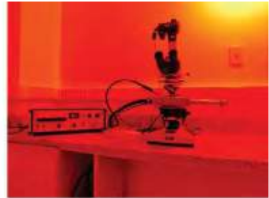
c: Microscopio de catodoluminiscencia GTL technosyn MKIII del Centro de Investigaciones Geológicas.
