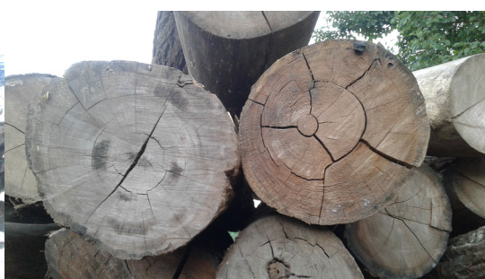
Imagen 4. Grietas y acebolladuras en especies de calidad C.
