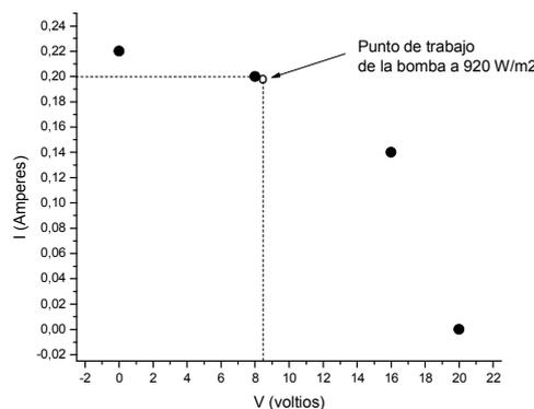
Figura 10. Punto de trabajo del sistema bomba- panel al medio día (I =920W/m<sup>2</sup>).
