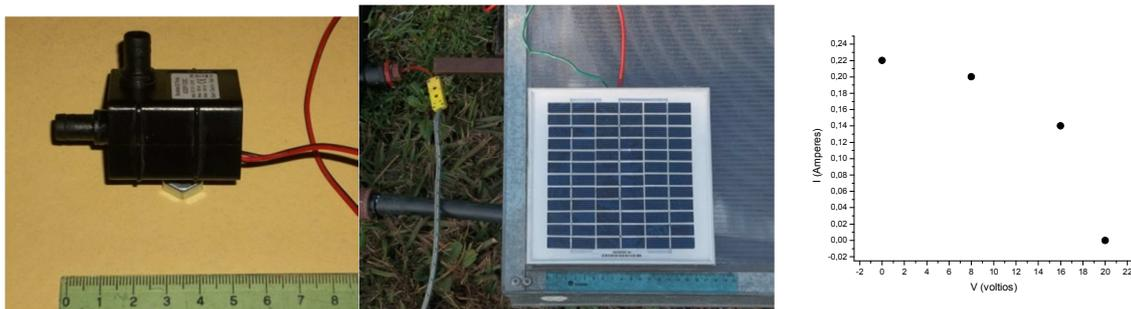
Figuras 6. Fotografías de la pequeña bomba de recirculación y del panel fotovoltaico utilizados en este trabajo, además la curva característica del panel a 1000W/m<sup>2</sup>.
