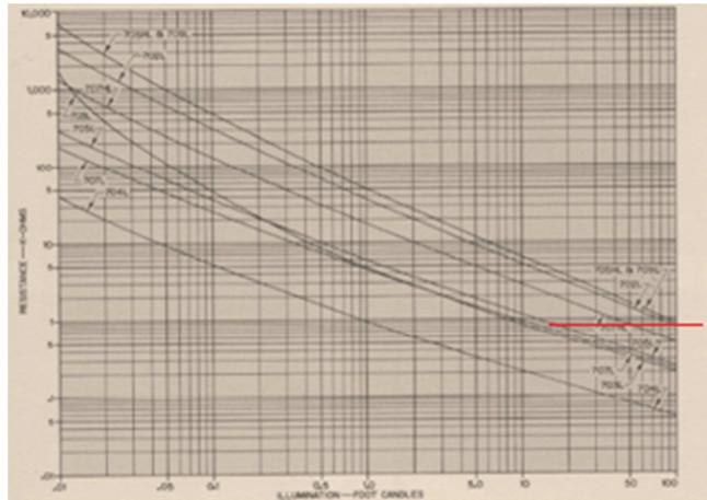
Figura 3: Características optoelectrónicas del sensor.
