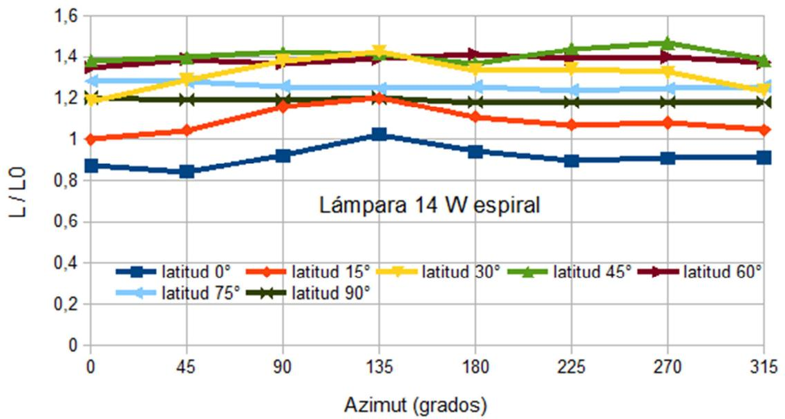
Figura 8: Iluminación en función del azimut, para distintas latitudes. Lámpara tipo espiral.
