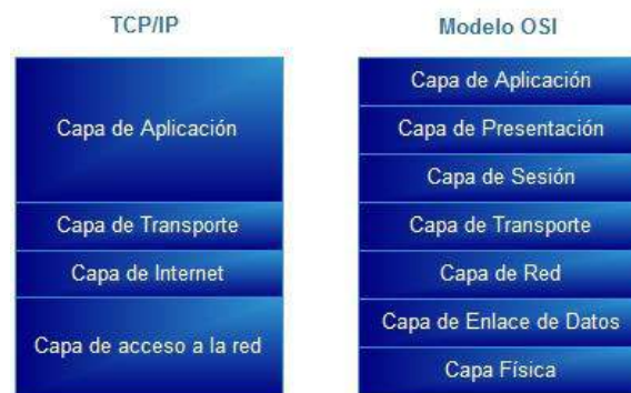
Figura 1: Comparación del Modelo OSI y TCP/IP
