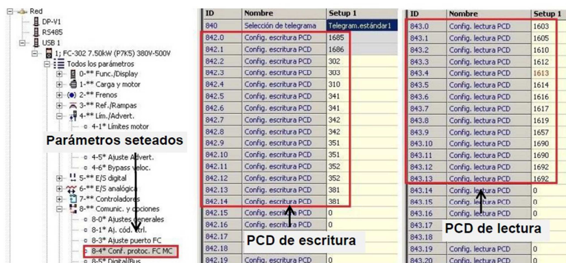
Figura 7: Configuración de los PCD de escritura y lectura sobre el MCT-100 del variador de frecuencia FC 302.
