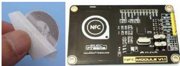
Figura N°4a. Tag NFC. N°4b Lector NFC.
