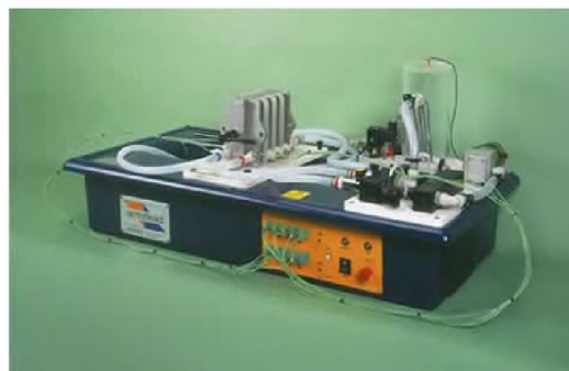
Figura 1. Intercambiador de calor Armfield HT30XC
