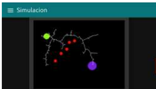
Fig. 10 Simulación de la ejecución del algoritmo RRT.
