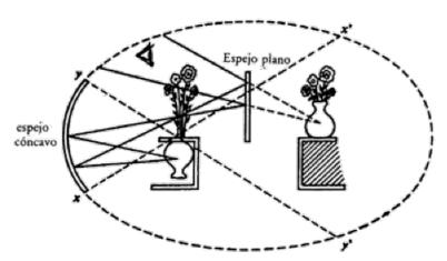
La imagen real que, como decíamos, resulta de la colocación del espejo cóncavo, se puede comportar como un objeto cuando se refleja en un nuevo espejo: el espejo plano. Se producirá entonces una imagen virtual de la imagen real.
