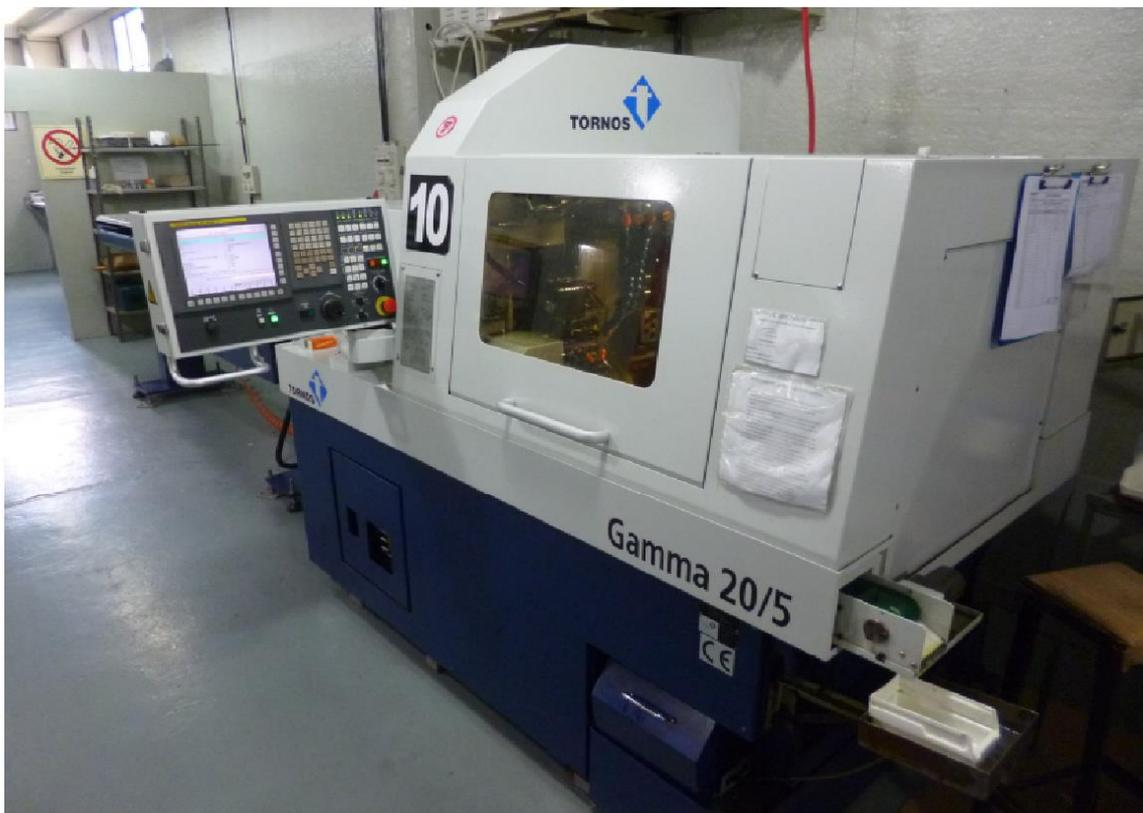
Figura 4.2: Torno CNC TORNOS Gamma 20/5. (Kinetical SRL, Berazategui, Argentina).
