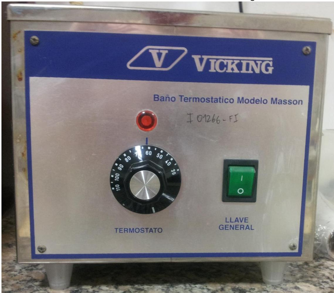
Figura 4.7: Baño termostático Vicking modelo Masson, perteneciente al Laboratorio en Investigaciones en Metalurgia Física (LIMF), La Plata, Argentina.
