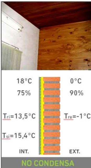
Figura 5.6: Ejemplo de solución para evitar la condensación de un cerramiento. Fuente: propia.
